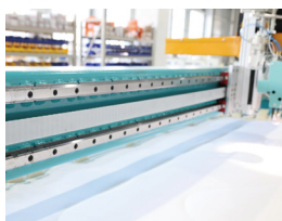
高精直线导轨，保证机头、鞍架高速运行平稳
